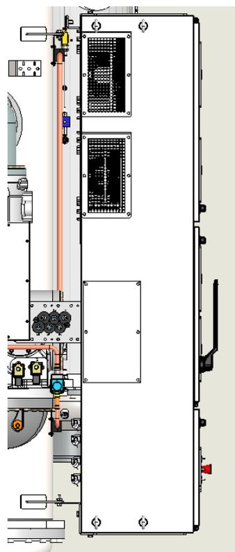
Электрическая панель большая: в этом случае сначала панель располагается на раме установки, затем она должна быть подключена к установке со стороны испарителя через монтажные кронштейны (см. рисунок ниже) с помощью винтов, поставляемых с установкой.
