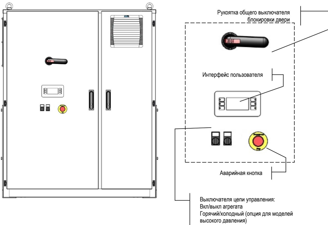
Рис. 15. Интерфейс агрегата
