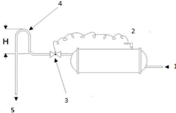
Рис. 13. Схема управления конденсацией при использовании артезианской воды
