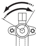
Отвинчивается против часовой стрелки
