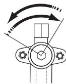
Отвинчивается против часовой стрелки
