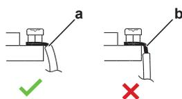
**a** Снимите изоляцию на конце провода до этого места
