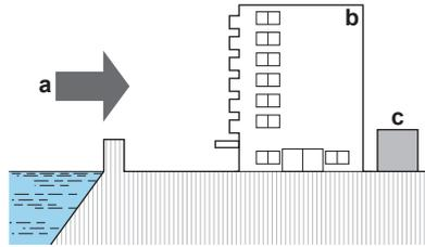
Если наружный агрегат подвергается прямому воздействию морских ветров, установите ветрозащитный щит.
