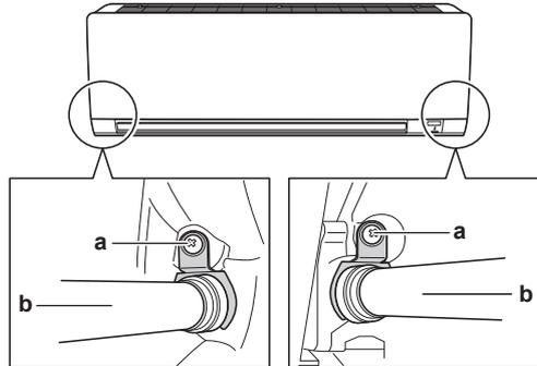
**a** Крепежный винт для изоляции
