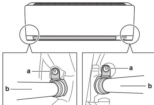
**a** Крепежный винт для изоляции
