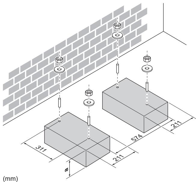
a 100 мм над расчетной поверхностью снежного покрова
