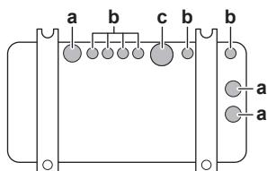
**a** Сливное отверстие. Установите заглушку сливного отверстия (2).
