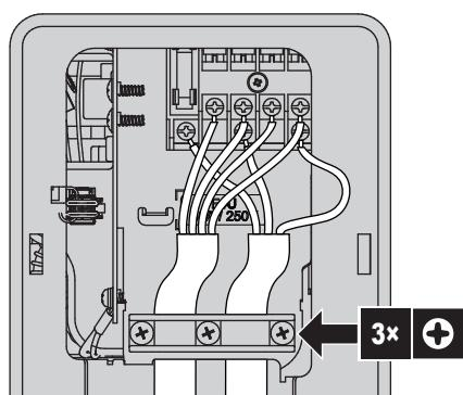
**5** Надежно затяните винты клемм. Рекомендуется пользоваться крестовой отверткой.
